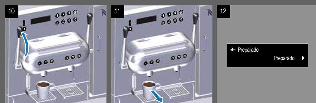
Suba la palanca para expulsar la cápsula usada.
