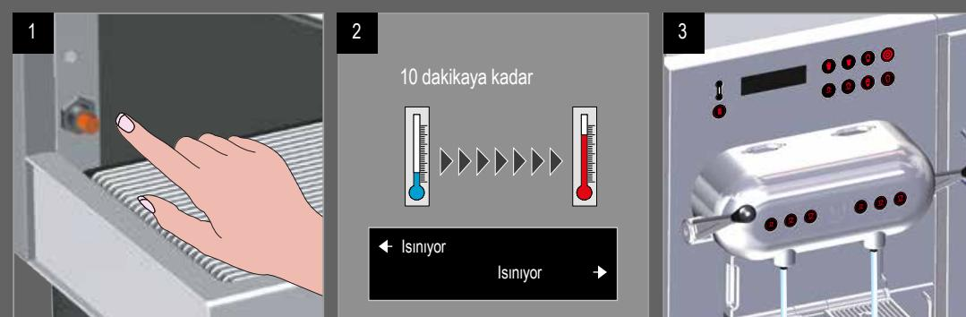
Dört saat boyunca kullanılmadıysa, makine maksimum enerji tasarruf moduna geçer. Isıtıcı kapatılır, soğutucu çalışmaya devam eder.
