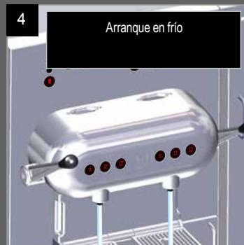
La máquina realiza un enjuague de arranque en frío (en la pantalla aparece un temporizador).
